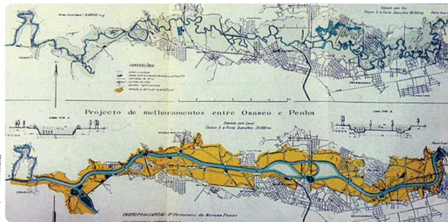
Projeto de retificação do leito do Tietê na cidade de São Paulo, sendo que a área laranja, da várzea, era para ter sido transformada num parque.
